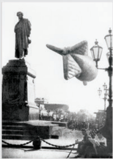
ВО ВРЕМЯ ВОЙНЫ ЗАГРАДИТЕЛЬНЫЕ АЭРОСТАТЫ ШИРОКО ПРИМЕНЯЛИСЬ ДЛЯ ЗАЩИТЫ ГОРОДОВ, ПРОМЫШЛЕННЫХ РАЙОНОВ, ВОЕННО-МОРСКИХ БАЗ И ДРУГИХ ОБЪЕКТОВ ОТ НАПАДЕНИЯ С ВОЗДУХА. НАЛИЧИЕ В СИСТЕМЕ ПВО АЭРОСТАТОВ ЗАГРАЖДЕНИЯ ВЫНУЖДАЛО САМОЛЕТЫ ПРОТИВНИКА ЛЕТАТЬ НА БОЛЬШИХ ВЫСОТАХ И ЗАТРУДНЯЛО ПРИЦЕЛЬНОЕ БОМБОМЕТАНИЕ С ПИКИРОВАНИЯ.
